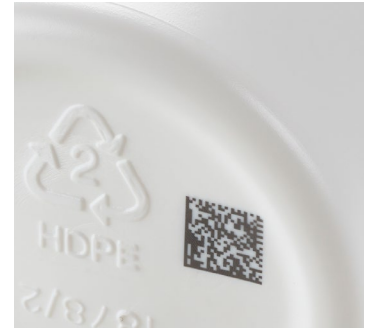
Videojet 7810 레이저 시스템은 자외선 파장을 활용하여 HDPE 포장에 고해상도의 영구적인 코드를 생성합니다.
